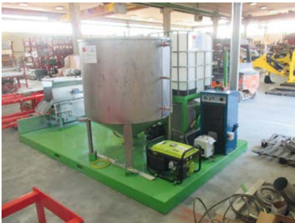
Impianto Spapperi per l'estrazione del colore indaco.
